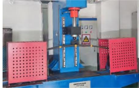
图 12 板簧试验机加载过程示意图
