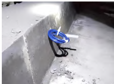
图 11 底座板混凝土测点
