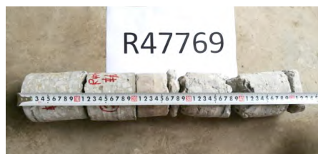
图 7 轨道板下劣化区钻芯取样结果
