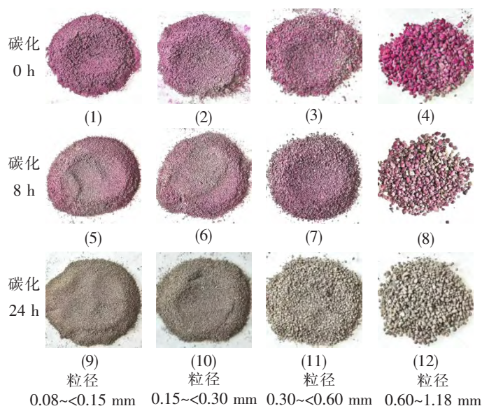
图 1 不同碳化时间钢渣砂的酚酞显色图片
