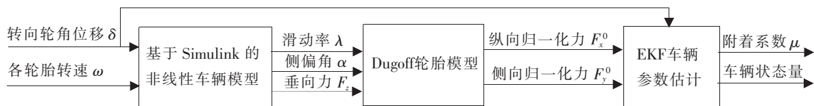
图 5 基于 EKF 的路面附着系数的算法原理图
