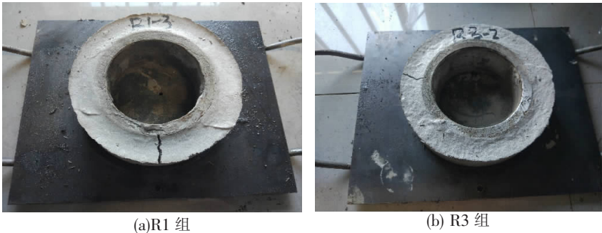
图 1 环形约束收缩试件裂缝图
