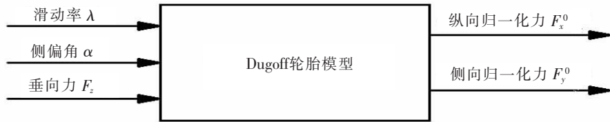
图 2 Dugoff 轮胎模型原理图
